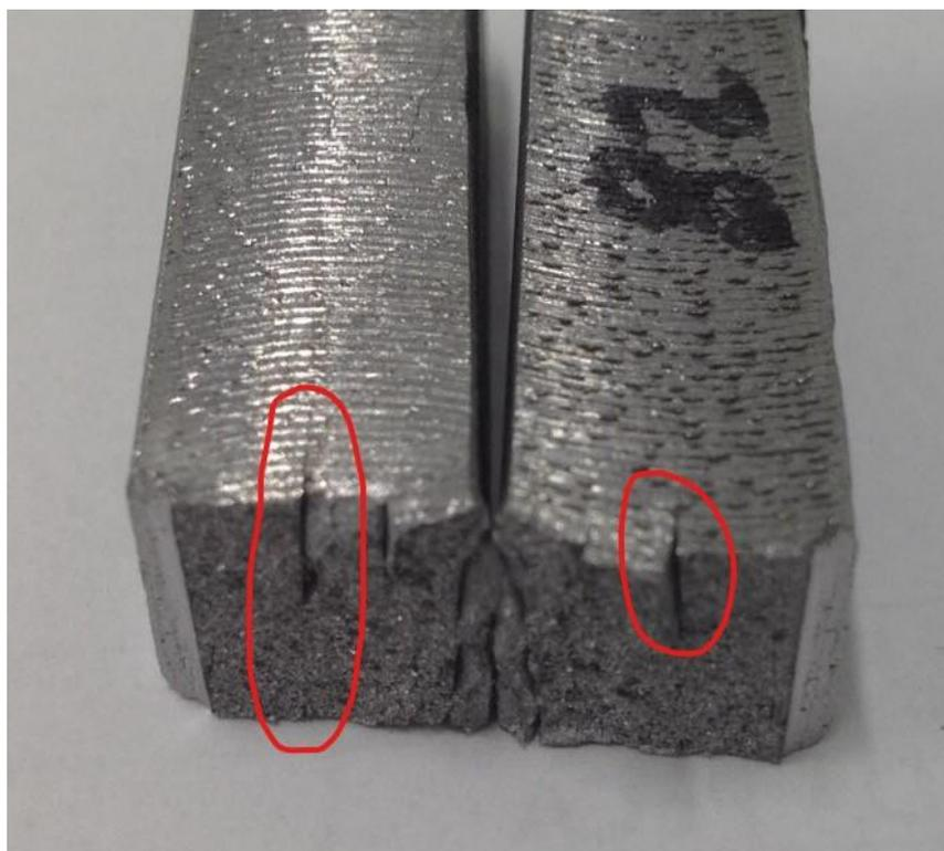
Figura 15 – Separação da solda.
