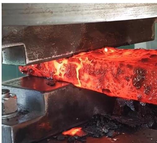
Figura 7 – *billet* sendo prensado.
