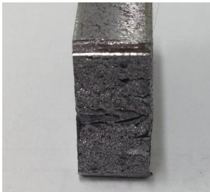
Figura 14 – Corpo de prova fraturado.
