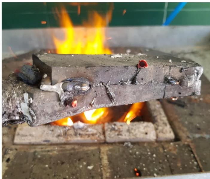
Figura 8 – *billet* cortado e soldado em novo bloco com 12 camadas.
