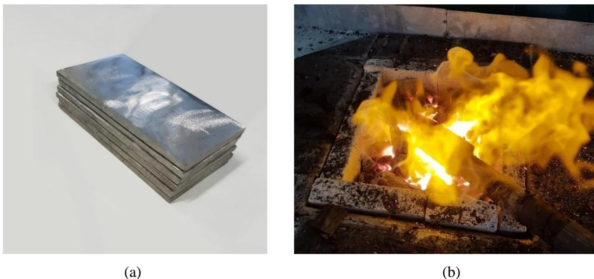
Figura 6 – (a) Bloco de 6 camadas iniciais; (b) Bloco sendo aquecido.
