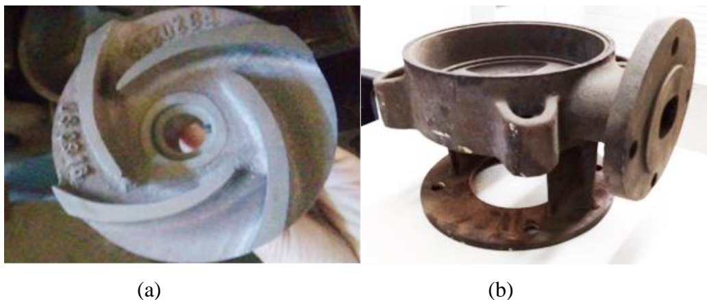
Figura 5 – (a) Rotor semiaberto (b) carcaça da bomba centrífuga de ferro fundido branco
