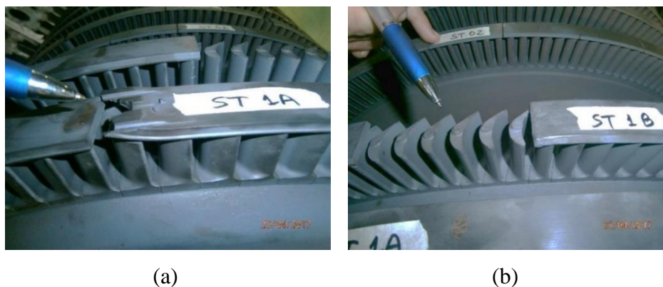
Figura 1 – Desprendimento das bandagens nos estágios 1A e 1B.
