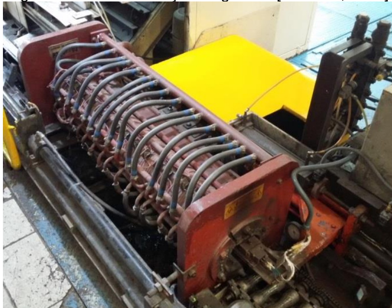
Figura 7: Forno de indução magnética [Do autor, 2018].
