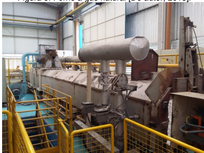
Figura 8: Forno a gás natural [Do autor, 2018].
