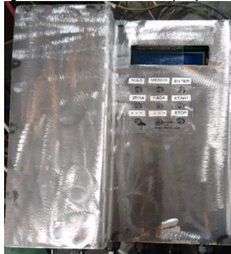
Figura 9: Painel elétrico projetado.
