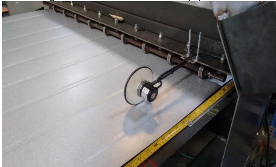
Figura 13: Encoder instalado no equipamento.
