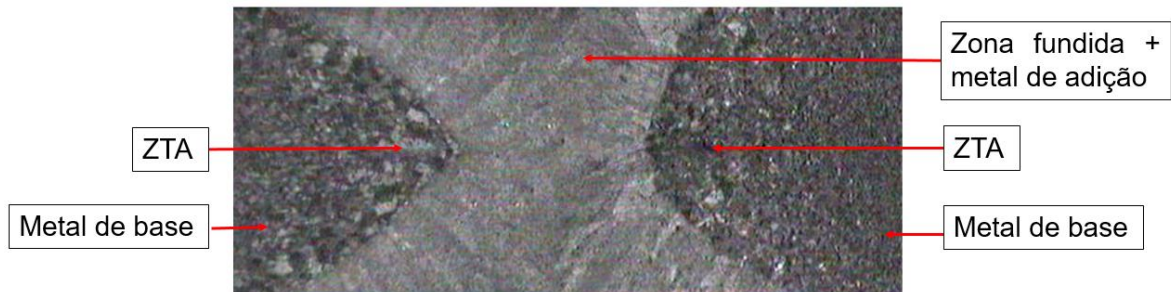
Figura 17: Macrografia do cordão de solda com pré-aquecimento.
