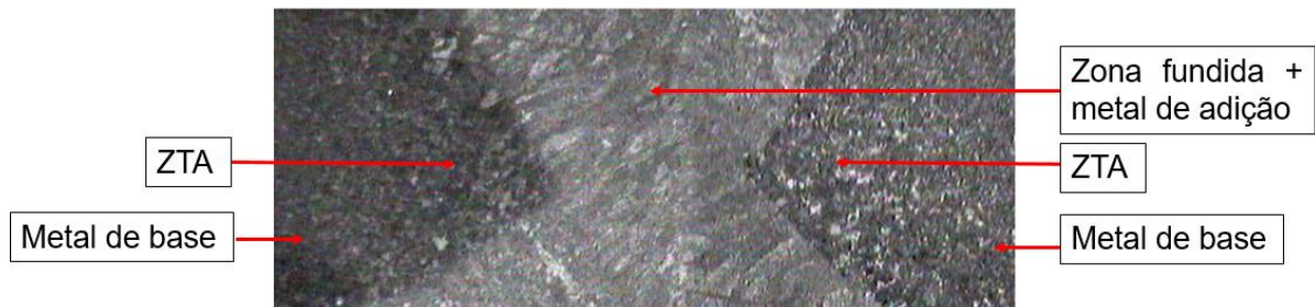
Figura 16: Macrografia do cordão de solda sem pré-aquecimento.
