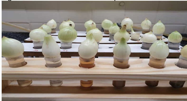
Figura 4: Biotestes com Allium cepa L. em tubos Falcon.
