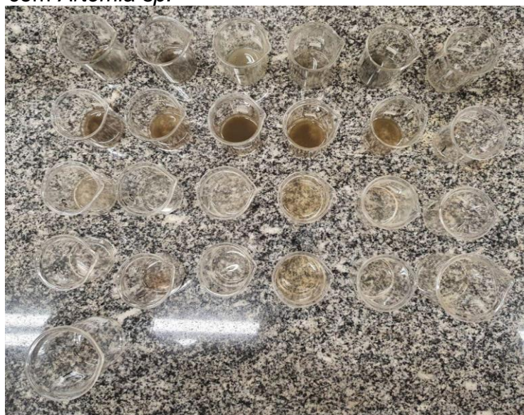
Figura 5: Ensaio de ecotoxicidade em poços de placas com Artemia sp.
