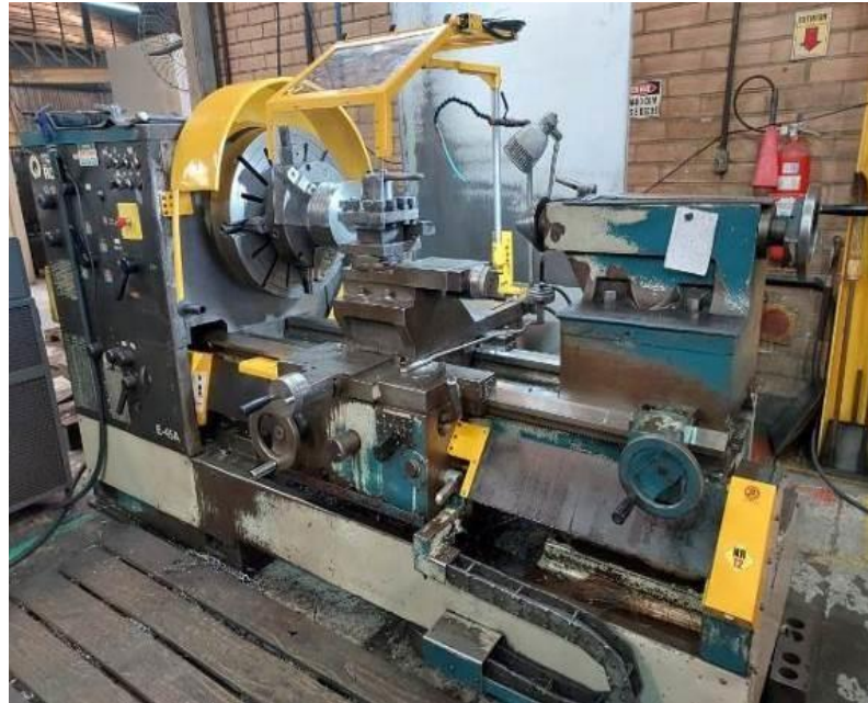
Figura 9: Torno convencional adequado conforme NR-12.
