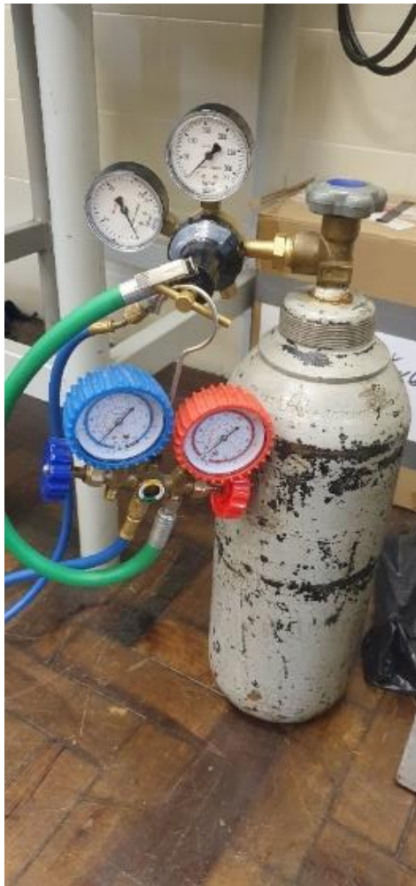
Figura 16: Garrafa de nitrogênio 1m 3 com regulador de pressão de alta e manifold
